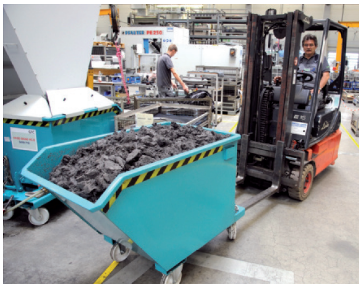
Die einzigen manuellen Vorgänge stellen der Transport der Sammelbehälter mit Schleifschlämmen oder Frässpänen zur Brikettierpresse und das Abkippen in den Trichter dar.
