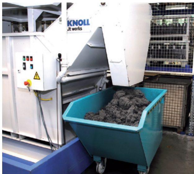
Rund 50 Tonnen Schleifschlamm und 70 Tonnen Frässpäne fallen bei GFC Antriebssysteme jährlich an. Aus ihnen werden in der Brikettieranlage fast 30 Tonnen Öl herausgepresst.
