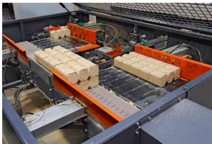
Zur Vorbereitung auf die endgültige Verpackung werden die Holzbriketts in zwei Lagen gestapelt
