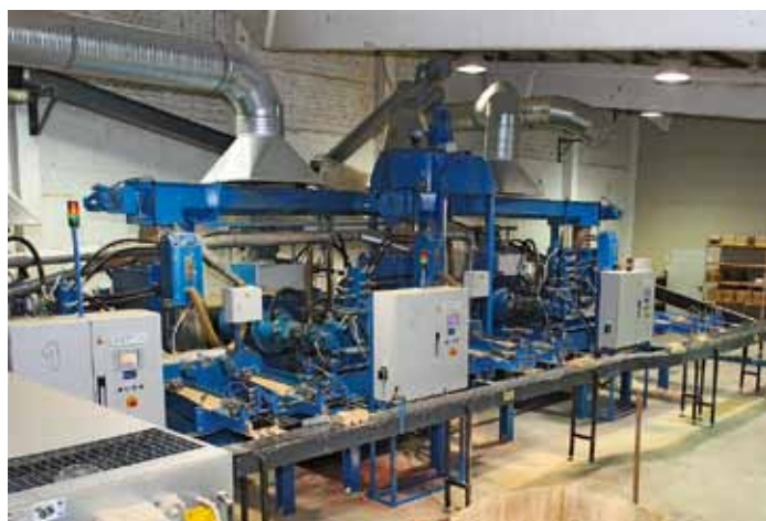
Drei Brikettierpressen von Ruf erzeugen bei Robeta Holz knapp 3 t Holzbriketts pro Stunde – Platz für eine vierte Presse ist vorhanden
