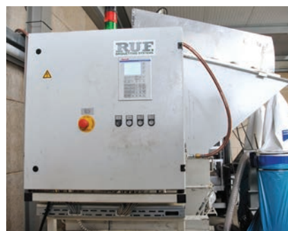
Bild 3: Mannloser Betrieb: Die Brikettierpresse erkennt, ob sich Material in dem Trichter befindet und schaltet sich automatisch ein und aus. Das Bedienpanel dient nur der Kontrolle und zur Änderung von Einstellungen.
