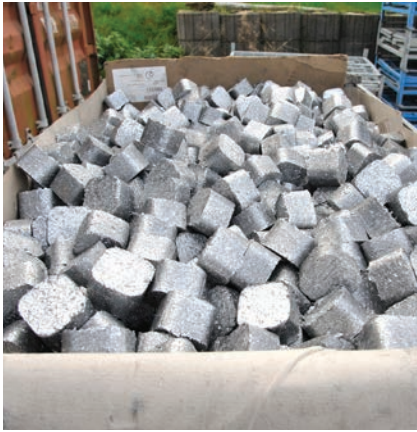
Bild 4: Nach dem Pressen beanspruchen die Aluminiumabfälle kompakt kaum mehr Platz als massive Alu-Blöcke.
