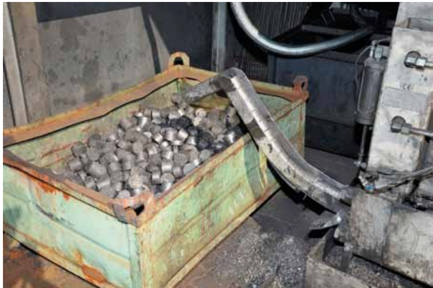
Bild 2: Die Presse wirft die Briketts aus Gussspänen – bis zu 120 kg pro Stunde – direkt in den Sammelbehälter aus
