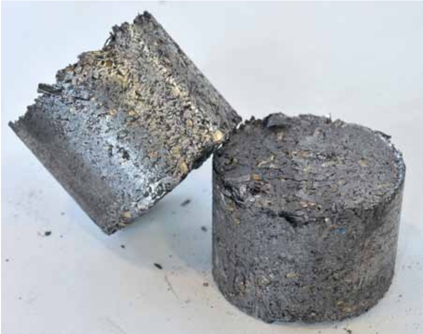
Bild 5: 60 mm Durchmesser, etwa 40 mm Dicke und 600 Gramm schwer. So lassen sich die gepressten Späne problemlos einschmelzen
