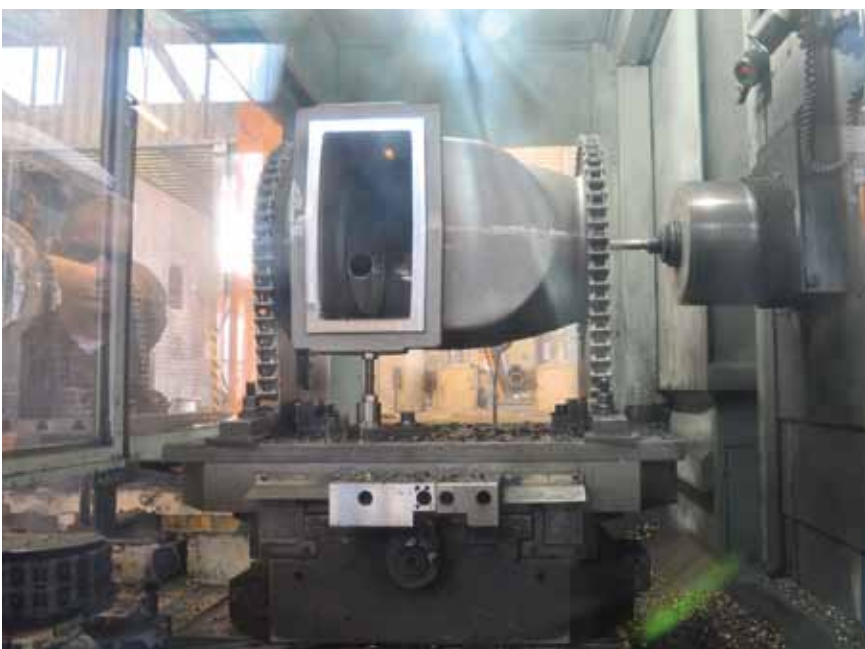
Bild 6: Spanende Bearbeitung: Um Korrosion von vornherein auszuschließen, werden die Teile ausschließlich trocken gefräst, gedreht und gebohrt (Werkbilder: Ruf Maschinenbau GmbH & Co. KG, Zaisertshofen)
