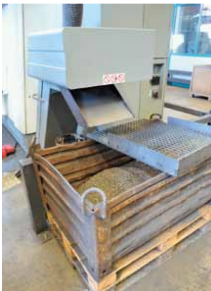
Bild 3: Direkt an den Bearbeitungszentren werden die beim Fräsen, Drehen und Bohren anfallenden Gussseisenspäne gesammelt
