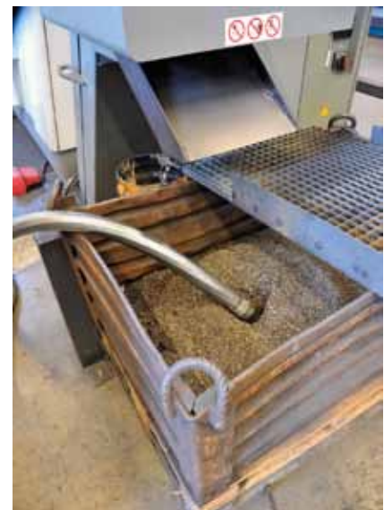
Bild 4: Wenn der Sammelbehälter voll ist, hängen Mitarbeiter einen Saugrüssel hinein, der die Späne über ein Absaugsystem zur Brikettierpresse transportiert
