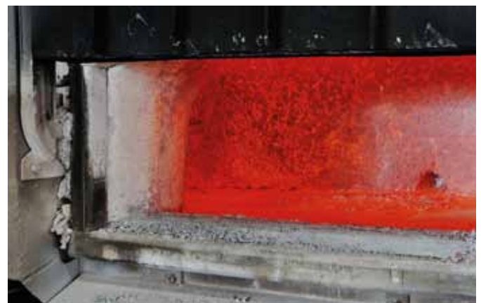
Bild 8: Angekaufter Aluminiumschrott und die Alu-Briketts aus eigener Herstellung werden bei HMT im Trommelherdofen eingeschmolzen und zu 7 und 8 Zoll dicken Aluminiumrundbarren gegossen
