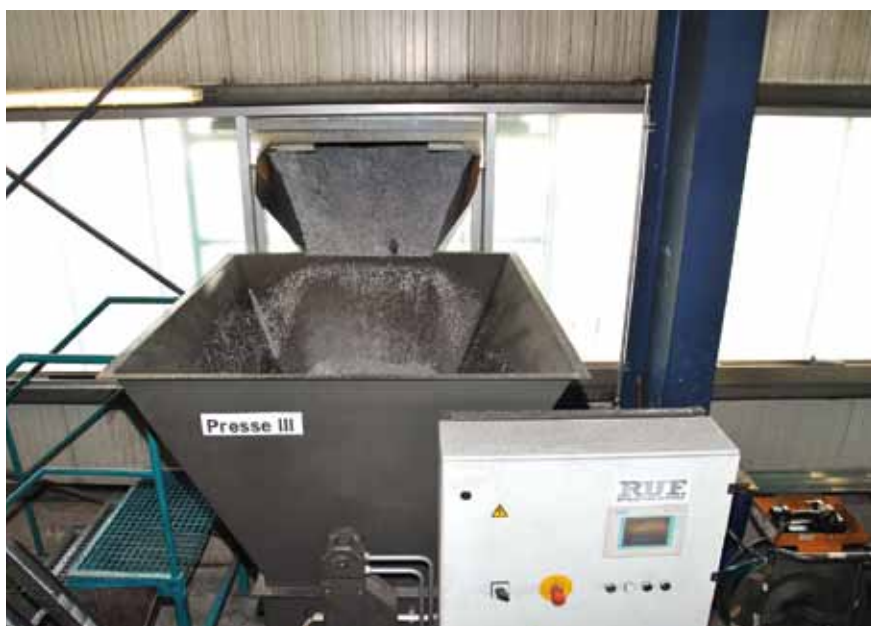
Bild 1: RUF-Brikettierpresse 4/3700/60x40 bei HMT: Die Anlage arbeitet innerhalb der Halle, mit Alu-Spänen befüllt wird sie durch eine Öffnung in der Wand von außen
