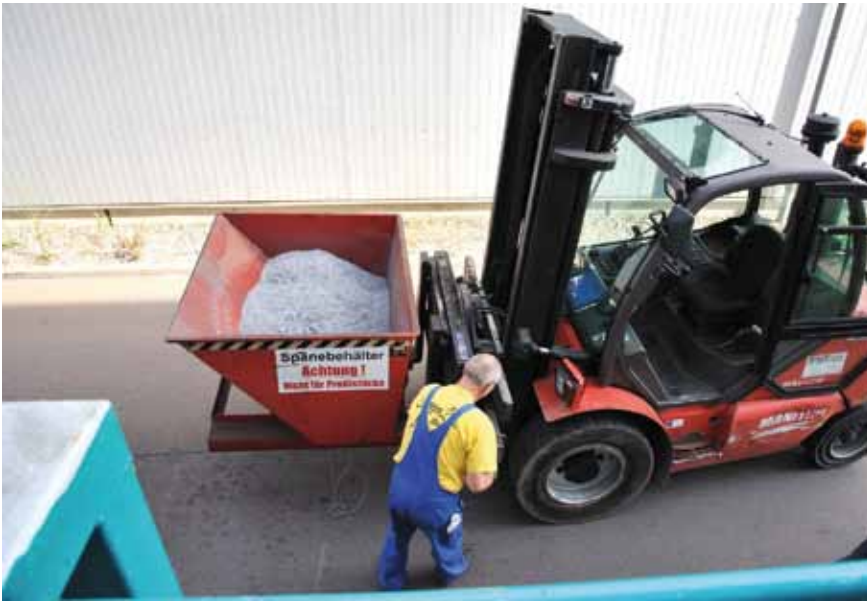
Bild 6: Nachschub für die Presse: Per Gabelstapler werden die an den Werkzeugmaschinen gesammelten Aluminiumspäne zur Presse transportiert und gelangen dann durch einen an der Außenwand montierten Trichter in die Brikettieranlage
