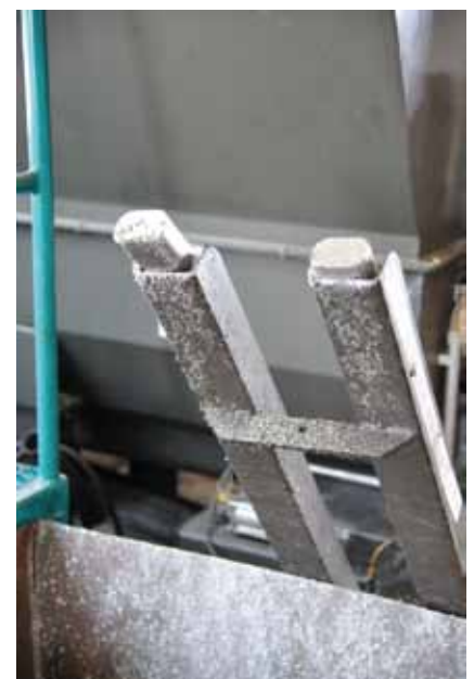
Bild 2: Über Auslaufschienen werden die Aluminiumbriketts in einen Sammelbehälter transportiert
