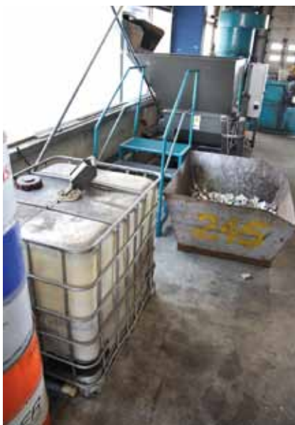
Bild 4: Aus 100 kg Aluminiumspänen werden etwa 10 kg Kühlschmierstoffe herausgepresst. Die Emulsionen werden in einen Tank neben der Presse gepumpt
