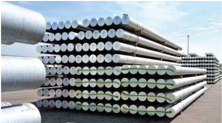
Bild 9: Materiallager: HMT presst in Hettstedt aus Aluminiumbolzen wie diesen verschiedenste Aluminiumprofile
