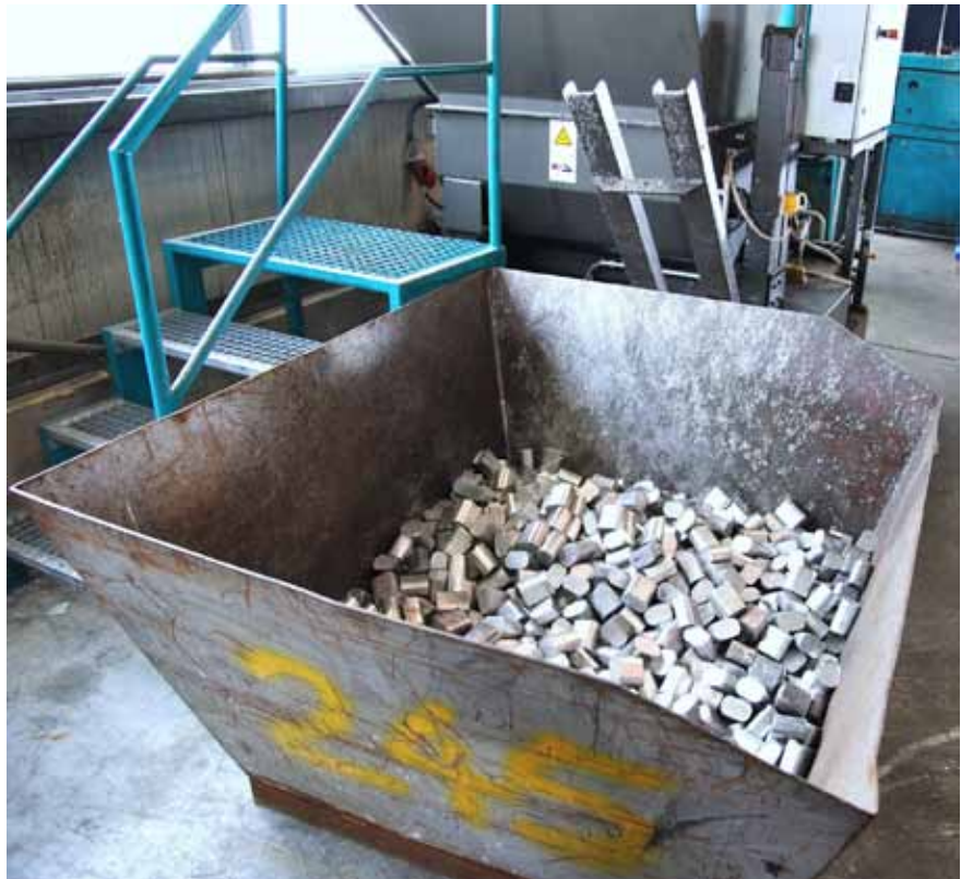
Bild 3: Rund 50 Tonnen Briketts stellt die Presse pro Jahr aus den Aluminiumspänen her, die beim Sägen, Bohren und Fräsen anfallen
