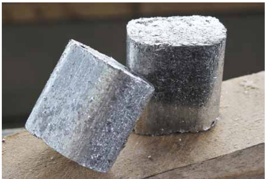
Bild 5: Um den Faktor sechs werden die Aluminiumspäne beim Verpressen komprimiert. Die Briketts messen 60 x 40 mm und haben eine Dichte von 2,3 kg/l
