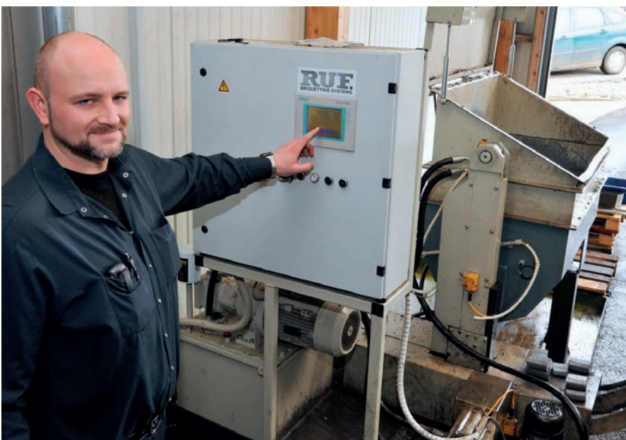
Bild 5: Alexander Fröhlich ist mit der Brikettierpresse rundum zufrieden: „Die Anlage arbeitet sehr zuverlässig“, sagt der Fertigungsleiter (Werkbilder: RUF Maschinenbau GmbH & Co. KG, Zaisertshofen)
