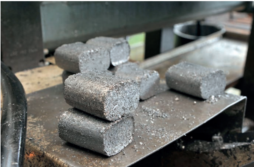
Bild 2: Trocken und kompakt statt nass und voluminös: Beim Brikettieren schrumpft das Volumen der Drehspäne auf einen Bruchteil und das Schneidöl wird herausgepresst
