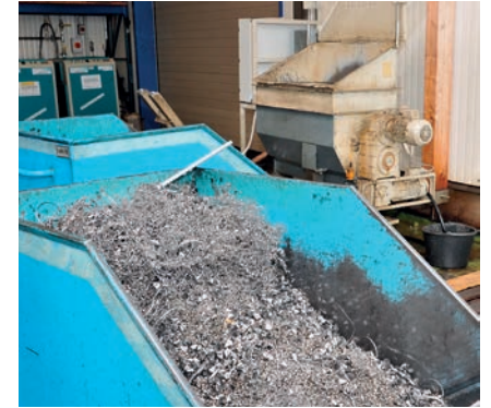
Bild 4: Span ist nicht gleich Span: Da das Schüttvolumen der Späne sehr unterschiedlich ist, können die jeweiligen Maschinenparameter durch einen Materialwahlschalter schnell ausgewählt werden
