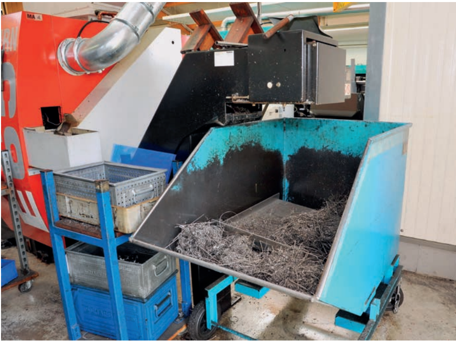
Bild 3: An jeder Drehmaschine fängt ein Vorratsbehälter die Edelstahlspäne auf
