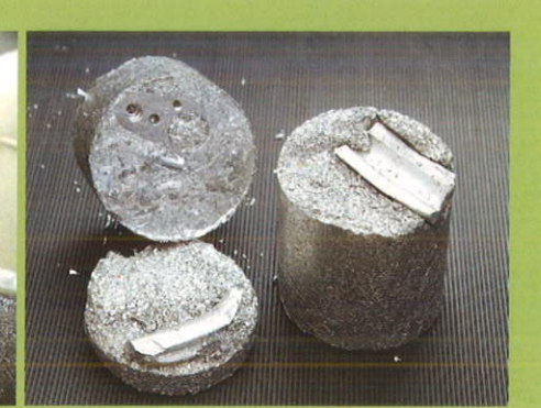
04 Grobteile, die sich zwischen den Spänen befinden, presst die RUF-Brikettieranlage problemlos in die Aluminium-Briketts mit ein
