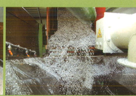
03 Späne, die beim Bohren und Fräsen anfallen, werden chargenweise der Presse zugeführt
