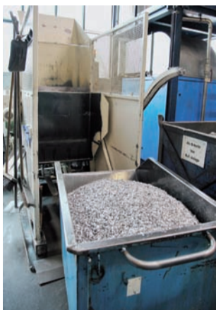
Kompakte Presse: Seit 2001 komprimiert die kompakte Anlage von Ruf bei ZF Gusstechnologie zuverlässig Aluminiumspäne zu Briketts
