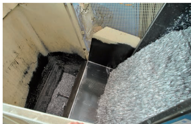
Das Einfüllen der Alureste in den Vorratsbehälter der Presse (links) erfolgt mit einer in die Anlage integrierten Kippvorrichtung.
