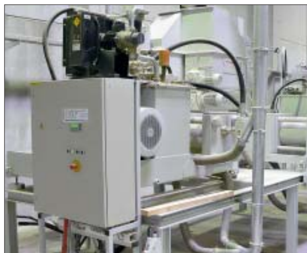
Alle sieben Sekunden verlässt jede Presse ein Brikett.
