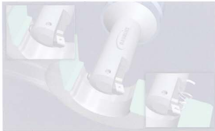
Bild: Das neue Kombiwerkzeug zur Bearbeitung von Pleuel-Augen wird auf der METAV zu sehen sein. In einer Aufspannung wird erst nach speziellen Vorgaben gedreht (rechts). Dann lenkt das Werkzeug aus (Mitte). Auf dem Rückweg gleitet der hochpräzise und feinstpolierte Diamant über die vorher zerspannte Fläche (links). Eine äußerst glatte Oberfläche mit verfestigten Randschichten entsteht (Werkbild: Baublies AG, Renningen)
