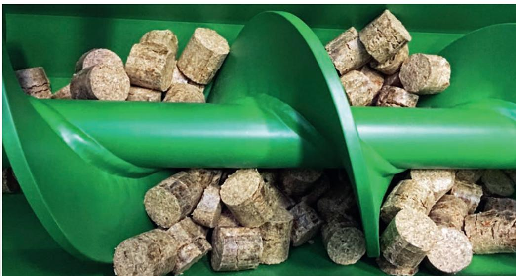
Parafuso alimentador com briquetes da prensa Briklet
