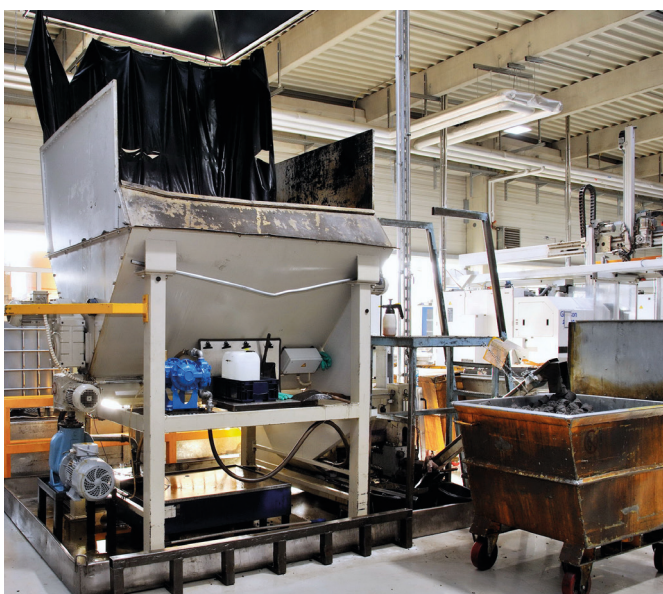
Im Dauereinsatz: Die RUF-Brikettieranlage im Werk Thyrnau hat seit 2007 rund 1,5 Millionen Liter Schleiföl aus Schleifschlämmen zurückgewonnen.
