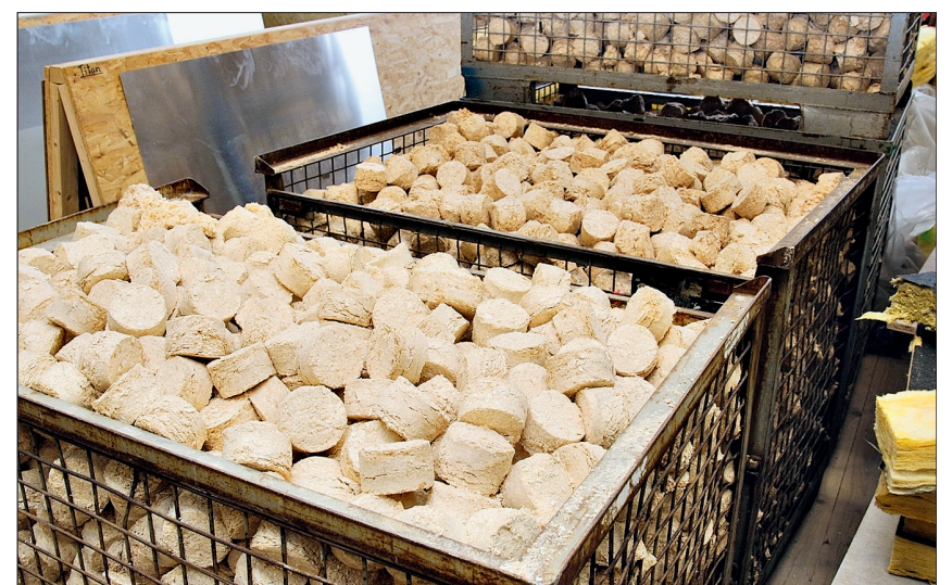
Zwischen 50 und 60 m³ Holzbricketts produziert der Zimmerer-Betrieb aus den anfallenden Hobelspänen. Die Lagerung erfolgt in Gitterboxen. Die Bricketts können verkauft werden, tragen also zur schnellen Amortisation bei
