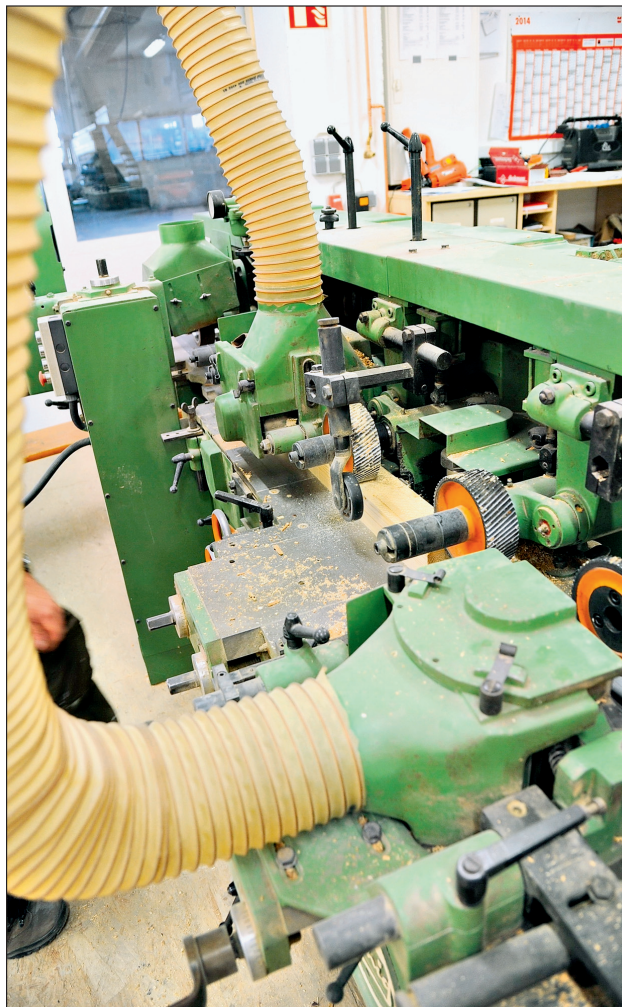
Vor allem wenn die Vierseiten-Hobelmaschine arbeitet, fallen viele Späne an. Absauganlagen transportieren diese direkt zum Vorratsbehälter der Brikettiermaschine
