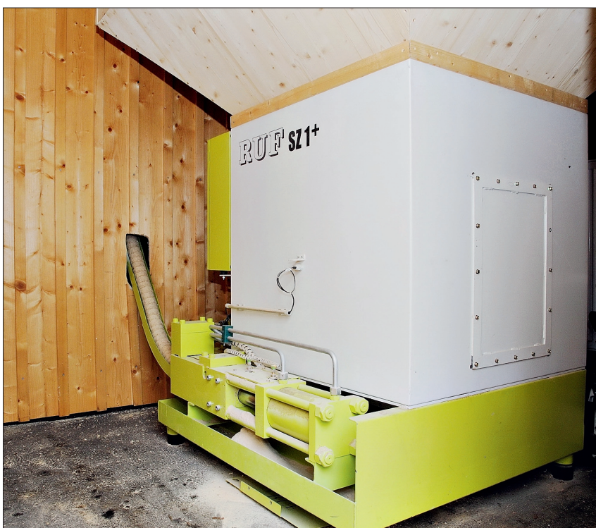
Die Ruf-Presse steht in einem maßgeschneiderten Anbau, der bei der Erweiterung fest eingeplant war
