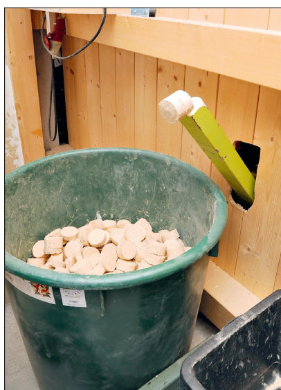
Über eine Auslaufrinne schiebt die Presse die fertigen Holzbricketts in bereitstehende Sammelbehälter
