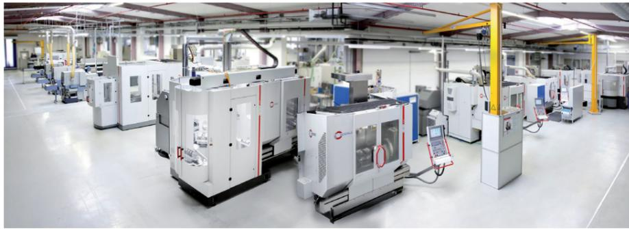
Auf 18 Fräszentren sowie acht Lang- und Kurzdrehautomaten werden in der CNC-Fertigung bei Zollner jährlich rund 250 Tonnen Aluminium bearbeitet
