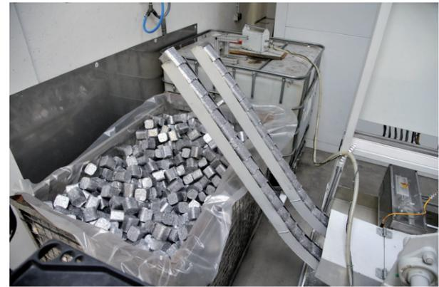
Über Auslaufschienen gelangen die Briketts aus der RUF-Presse in Sammelbehälter
